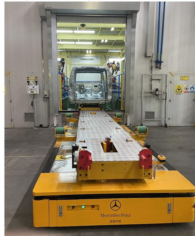
ユニットロード式ARM、長さ5600x幅1700mm、荷重2トン
